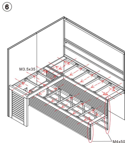
Montieren und verschrauben Sie die zuerst oberen Sitzunterkonstruktionen, sowie die oberen und seitlichen Blenden. Danach können die untere Sitzunterkonstruktionen, sowie die unteren Blenden montiert und verschraubt werden.
