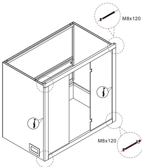
Montieren und verschrauben Sie den unteren und den seitlichen Teil des Rahmens der Vorderseite. Setzen Sie die seitlichen Glaselemente ein und montieren Sie den oberen Teil des Rahmens.
