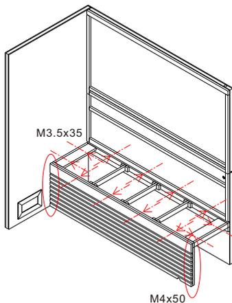
Montieren und verschrauben Sie die Sitzunterkonstruktionen und die vordere Blende.
