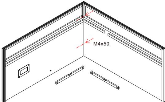
Stellen Sie sicher, dass der Boden eben ist. Montieren Sie als erstes den unteren Teil der rechten und linken Steinrückwand. Ziehen Sie danach die Schrauben fest.
