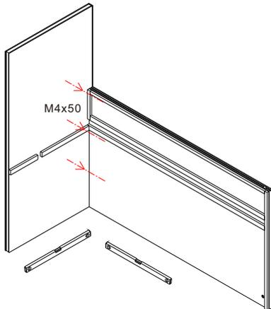
Stellen Sie sicher, dass der Boden eben ist. Montieren und verschrauben Sie die linke Rückwand (rechter Teil) mit dem unteren Teil der Steinrückwand.
