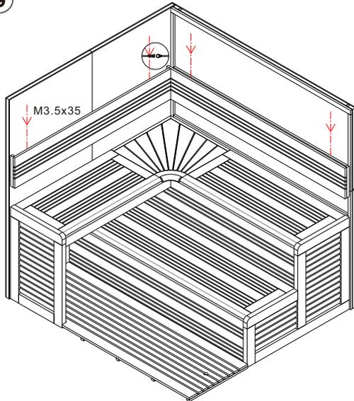
Montieren Sie je nach Modell den Saunaofen und verkabeln diesen, sowie die Beleuchtung. Montieren und verschrauben Sie zum Schluss die Sitze und die Rückenlehnen.
