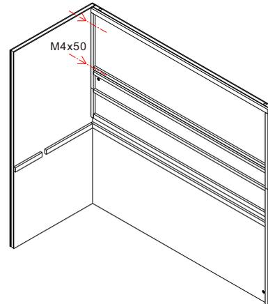
Montieren Sie danach den oberen Teil der Steinrückwand und verschrauben Sie diese wie in der Zeichnung angegeben.
