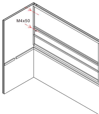
Montieren Sie danach den oberen Teil der Steinrückwand und verschrauben Sie diese wie in der Zeichnung angegeben.
