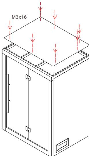
Montieren sie jetzt die Glastür und die Türgriffe. Zum Schluss kann die obere Dachplatte montiert und verschraubt werden.
