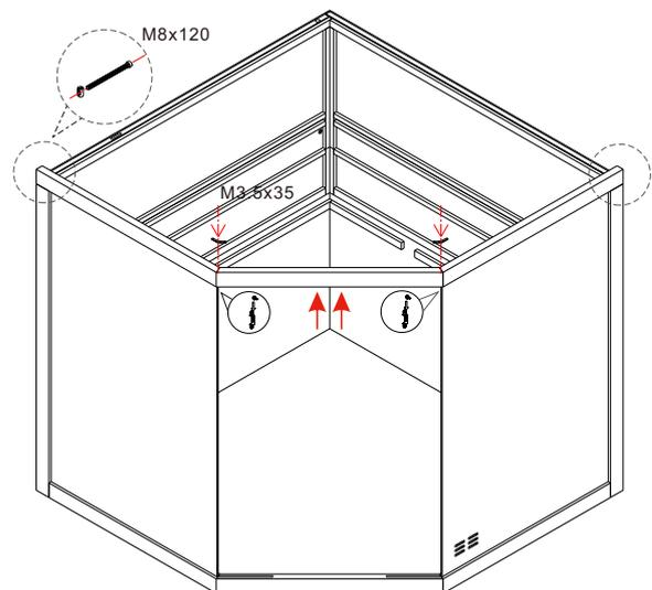
Montieren Sie jetzt die 3 oberen Rahmen. Ziehen Sie den oberen Rahmen hoch und setzen die beiden kleinen Scheiben ein. Die Tür bitte noch nicht montieren.
