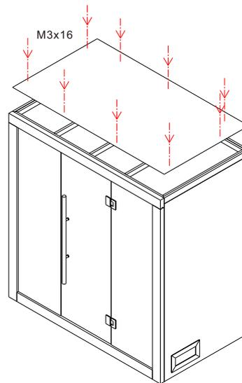
Montieren sie jetzt die Glastür und die Türgriffe. Zum Schluss kann die obere Dachplatte montiert und verschraubt werden.
