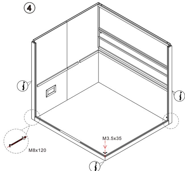
Verschrauben Sie die unteren & seitlichen Rahmen. Hängen Sie die Rahmen an den Saunawänden ein. Setzen Sie das linke (Luftschlitze) und rechte große Glaselement ein. Ziehen Sie die Schrauben fest.
