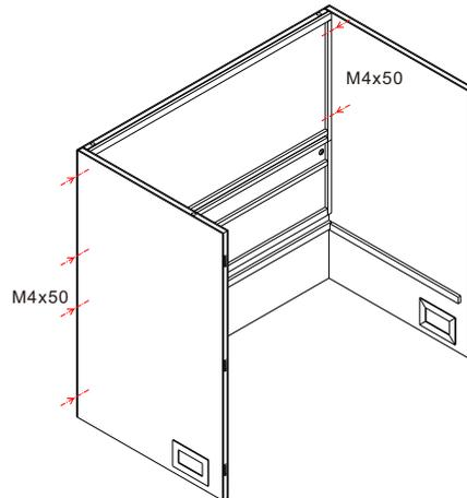
Montieren Sie danach den oberen Teil der Steinrückwand und verschrauben Sie diese wie in der Zeichnung angegeben. Im Anschluss kann die linke Seitenwand montiert und verschraubt werden.
