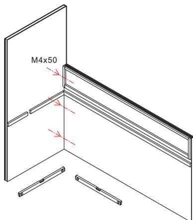
Stellen Sie sicher, dass der Boden eben ist. Montieren und verschrauben Sie die linke Seitenwand (rechter Teil) mit dem unteren Teil der Steinrückwand.
