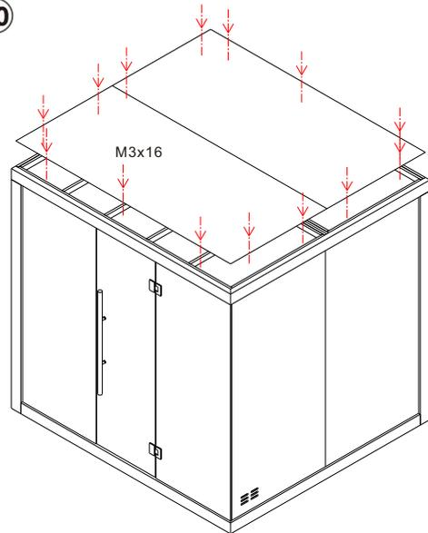
Montieren sie jetzt die Glastür und die Türgriffe. Zum Schluss kann die obere Dachplatte montiert und verschraubt werden.
