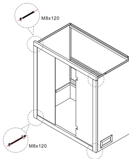
Montieren und verschrauben Sie den unteren und den seitlichen Teil des Rahmens der Vorderseite. Setzen Sie die seitlichen Glaselemente ein und montieren Sie den oberen Teil des Rahmens.
