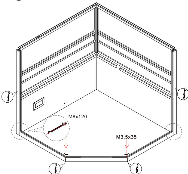
Verschrauben Sie die unteren & seitlichen Rahmen. Hängen Sie die Rahmen an den Saunawänden ein. Montieren Sie den unteren Türrahmen und ziehen Sie alle Schrauben fest. Setzen Sie das linke und rechte große Glaselement ein.
