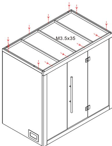
Montieren und verschrauben Sie die Dachelemente.
