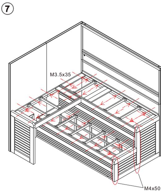
Montieren Sie jetzt die beiden oberen Rahmen. Ziehen Sie den oberen Rahmen hoch und setzen die beiden kleinen Scheiben ein. Die Tür bitte noch nicht montieren.
