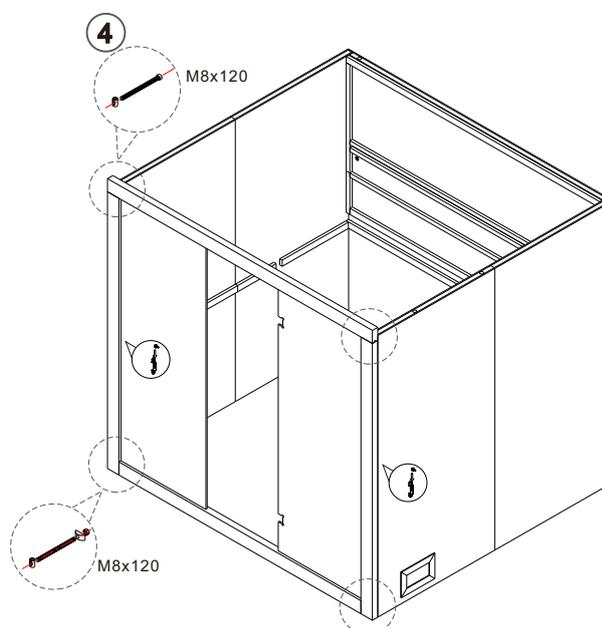
Montieren und verschrauben Sie den unteren und den seitlichen Teil des Rahmens der Vorderseite. Setzen Sie die seitlichen Glaselemente ein und montieren Sie den oberen Teil des Rahmens.
