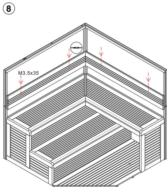
Montieren Sie den Saunaofen und verkabeln diesen, sowie die Beleuchtung. Montieren und verschrauben Sie zum Schluss die Sitze und die Rückenlehnen.
