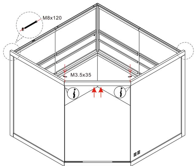
Montieren Sie jetzt die 3 oberen Rahmen. Ziehen Sie den oberen Rahmen hoch und setzen die beiden kleinen Scheiben ein. Die Tür bitte noch nicht montieren.
