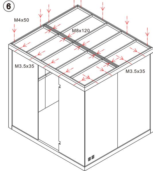
Montieren und verschrauben Sie die Dachelemente.
