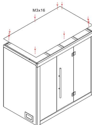
Montieren sie jetzt die Glastür und die Türgriffe. Zum Schluss kann die obere Dachplatte montiert und verschraubt werden.
