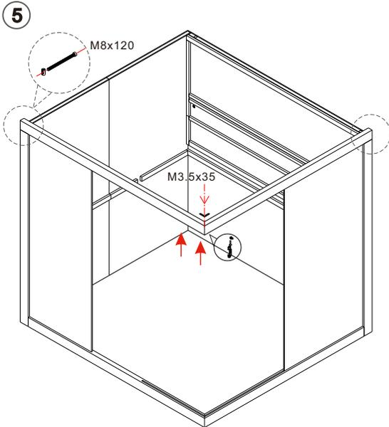
Montieren Sie jetzt die beiden oberen Rahmen. Ziehen Sie den oberen Rahmen hoch und setzen die beiden kleinen Scheiben ein. Die Tür bitte noch nicht montieren.
