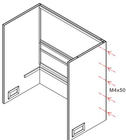
Verschrauben Sie den hinteren Teil der rechten Seitenwand mit der Steinrückwand.
