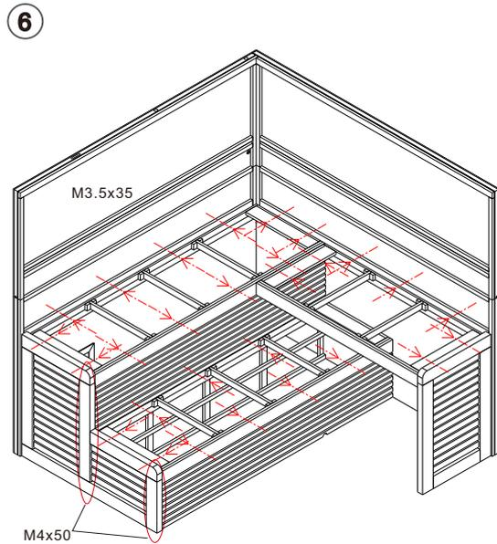
Montieren und verschrauben Sie die zuerst oberen Sitzunterkonstruktionen, sowie die oberen und seitlichen Blenden. Danach können die untere Sitzunterkonstruktionen, sowie die unteren Blenden montiert und verschraubt werden.
