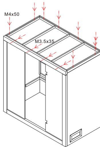
Montieren und verschrauben Sie die Dachelemente.
