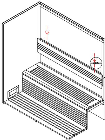
Montieren Sie je nach Modell den Saunaofen und verkabeln diesen, sowie die Beleuchtung. Montieren und verschrauben Sie zum Schluss die Sitze und die Rückenlehnen.
