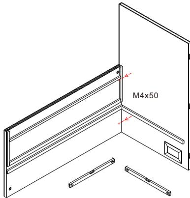
Stellen Sie sicher, dass der Boden eben ist. Montieren und verschrauben Sie die rechte Seitenwand mit dem unteren Teil der Steinrückwand.
