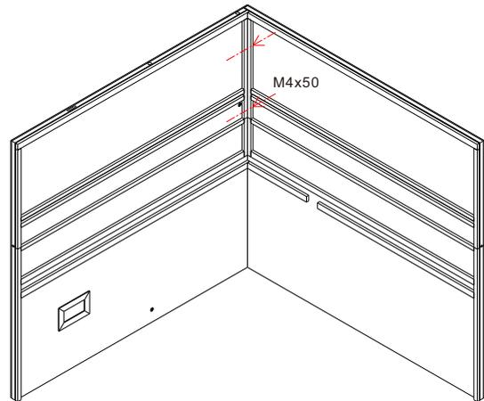
Montieren Sie als danach den oberen Teil der rechten und linken Steinrückwand. Ziehen Sie danach die Schrauben fest.
