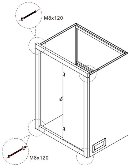
Montieren und verschrauben Sie den unteren und den seitlichen Teil des Rahmens der Vorderseite. Setzen Sie das seitliche Glaselement ein und montieren Sie den oberen Teil des Rahmens.
