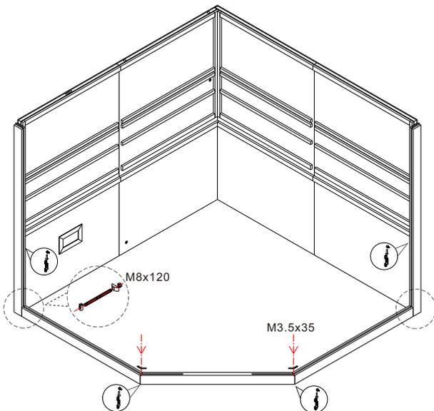
Verschrauben Sie die unteren & seitlichen Rahmen. Hängen Sie die Rahmen an den Saunawänden ein. Montieren Sie den unteren Türrahmen und ziehen Sie alle Schrauben fest. Setzen Sie das linke und rechte große Glaselement ein.
