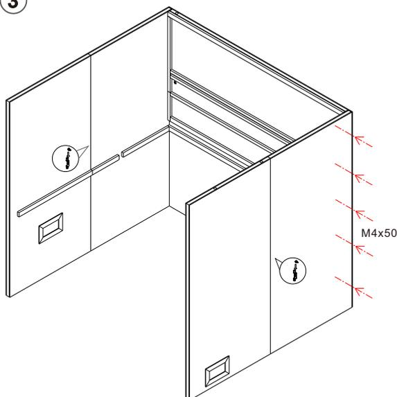
Hängen Sie jetzt den zweiten Teil der linken Rückwand ein. Verschrauben Sie den hinteren Teil der rechten Seitenwand mit der Steinrückwand und hängen danach den vorderen Teil ein.
