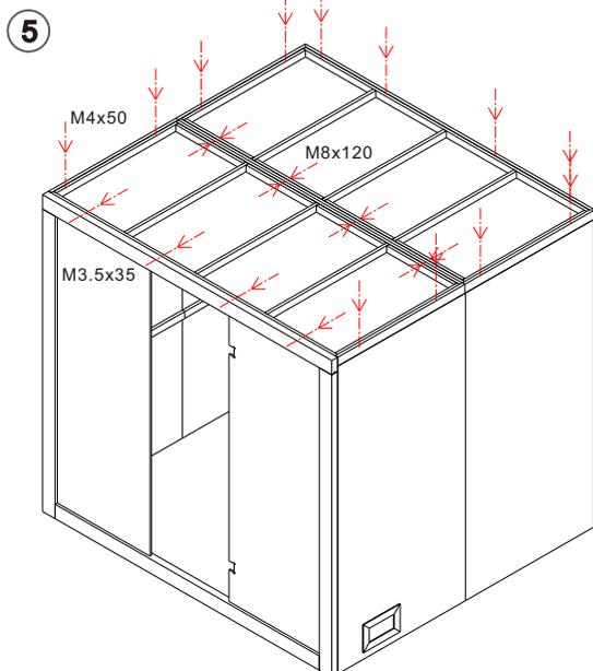
Montieren und verschrauben Sie die Dachelemente.
