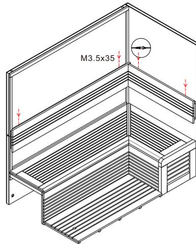
Montieren Sie je nach Modell den Saunaofen und verkabeln diesen, sowie die Beleuchtung. Montieren und verschrauben Sie zum Schluss die Sitze und die Rückenlehnen.
