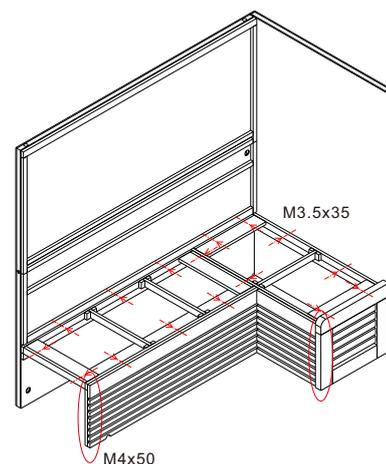
Montieren und verschrauben Sie die Sitzunterkonstruktionen und die vordere Blende.
