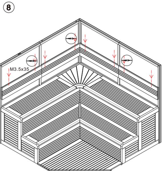
Montieren Sie den Saunaofen und verkabeln diesen, sowie die Beleuchtung. Montieren und verschrauben Sie zum Schluss die Sitze und die Rückenlehnen.
