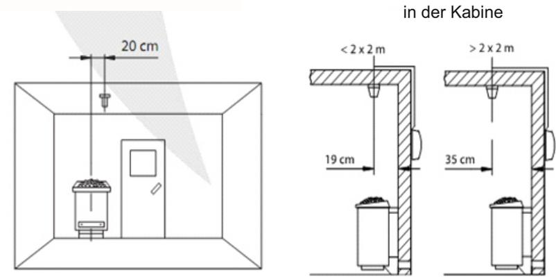
Diagramm für die Lichteinheit der Sauna
