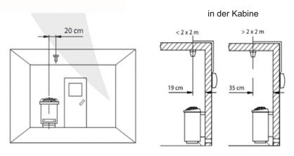
Diagramm für die Lichteinheit der Sauna
